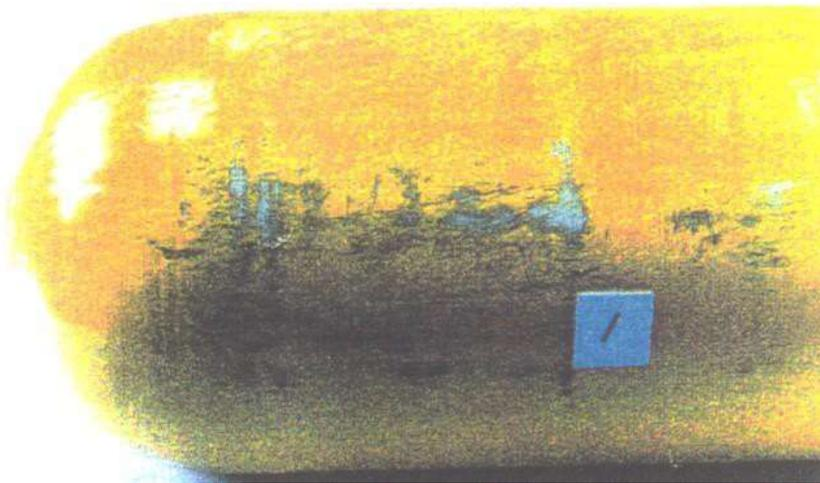
**a) Level 1 abrasion damage — Superficial abrasion**
